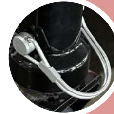
Opción de bloqueo de ruedas delanteras para trabajos en terrenos inclinados.
